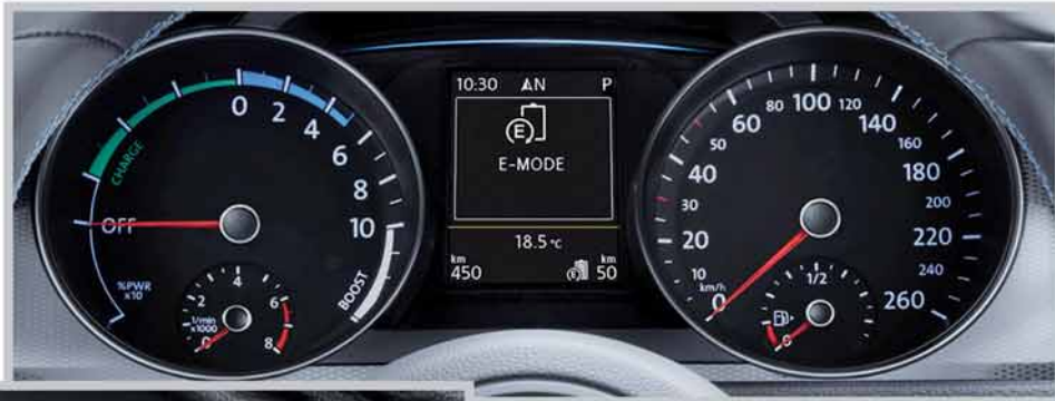
Schalttafeleinsatz mit GTE-spezifischen Anzeigen
