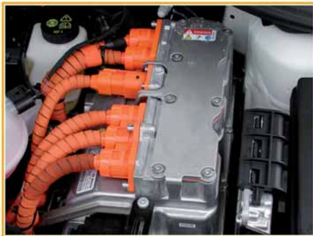
Leistungs- und Steuerelektronik für Elektroantrieb JX1
